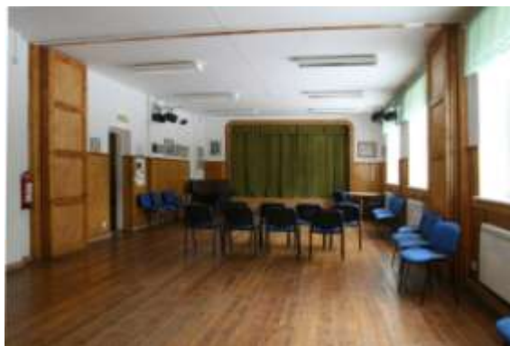
Foto 21. Neeme koolimajas Harjumaal on säilinud lava ja kahe klassi vaheline teisaldatav sein. Lisaks on koridorides ja klassiruumides 1,5 m kõrguseni ulatuvad seinapaneelid. S. Mälk, 2012.
